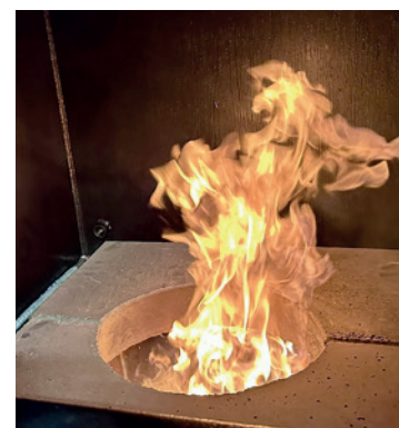
Erste Schnitzeln werden dem Ofen zugeführt und werden im Ofen gezündet!
