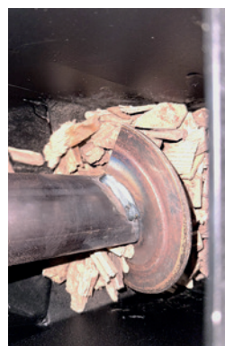
Erste Schnitzeln werden dem Ofen zugeführt und werden im Ofen gezündet!
